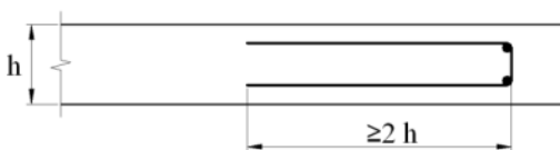
Рисунок 9.16 – Краевая арматура плиты
